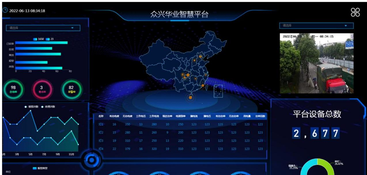
众兴华业智慧照明系统是利用计算机技术结合通信技术,通过“五遥”功能,对快速发展的道路照明系统实现自动化和智能化监控管理,从而达到预防事故的发生,提高照明质量及维护、检修效率;保证道路亮灯率和设备完好率、节约能源、减轻劳动强度,避免相关事故的发生。
